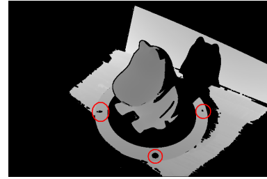
図4 LED部分の形状の欠損(赤丸で囲った部分がLEDのある位置)
